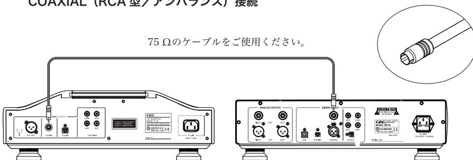
デジタルの COAXIAL ケーブルには方向性がありますので、(ケーブル表面に表示があります) 矢印の向かう方向に DAIN が来るように接続します。接続方向を逆にすると音質が劣化しますので向きを間違えないようご注意ください。
