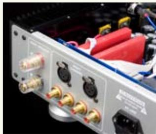
◀両サイドに大型ヒートシンクを配置、内部は完全左右対称の回路設計
